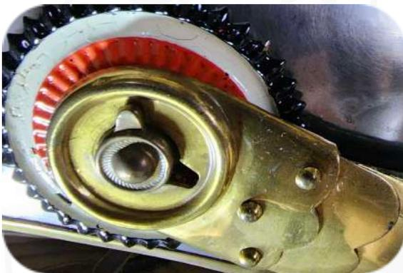
f) An beiden Seiten je eine zylindrische, durch zwei einander gegenüberstehende Haltestifte am Helm Kopf befestigte Rosette von 14 mm Durchmesser mit nach oben und etwas nach hinten gerichteter, 5 mm langer und 1,4 mm starker Nase, zur Befestigung des Kinnriemens bz. der Schuppenketten und der Kokarden.
